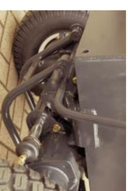
Sistema rápido de montaje y desmontaje de la plataforma de corte.
