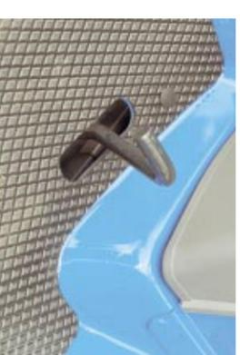
Bloqueo diferencial mediante pedal actuando sobre el eje trasero.
