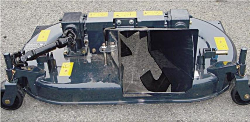
La plataforma de corte sin correas de fácil acceso (montaje y desmontaje) y fácil mantenimiento. La conexión de las cuchillas se realiza por dos grupos hidráulicos y palier.
