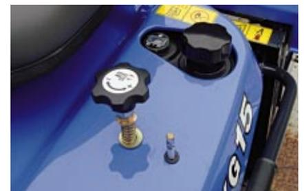
Indicador del nivel del combustible junto al tapón. Regulación micrométrica de la altura de corte (desde 25 a 120 mm.).
