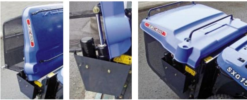
Saco recogedor con cilindro de elevación hidráulica.
